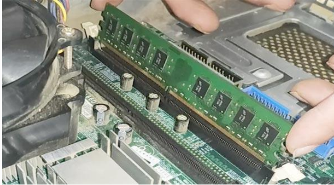
Fig: Install RAM
